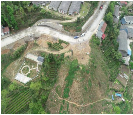
K20+790 (下边坡及时修建挡土墙并及时对渣场进行植被恢复)
