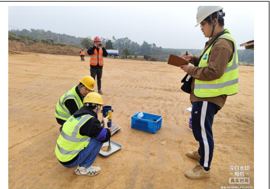
今日水印相机 真实时间 湖北省宜昌市峡州大道三期（杨家店……白洋）市政工程监理部 施工区 域: K15+180-235 施工内 容: 路基石方土质压实度检测 拍摄时 间: 2024.03.16 10:24:20 天 气: 轻雾 17℃ 地 点: 宜昌市·杨家湾 建设单位: 宜昌高新投资开发有限公司 监理单位: 中咨工程咨询有限公司 施工单位: 中国路桥集团第一工程有限公司 设计单位: 湖北省地质工程勘察院有限公司 勘察单位: 湖南化工地质工程勘察院有限公司 代建单位: 宜昌产投建设发展有限公司
