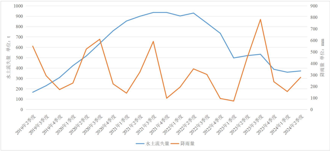
图3-2 项目区施工期水土流失量与降雨量折线对比图
